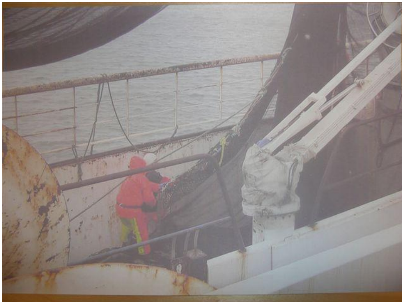
Figur 5: Det tidligere søgelænder før ændringen til den på ulykkesdagen aktuelle udformning. Foto: Rederiet
